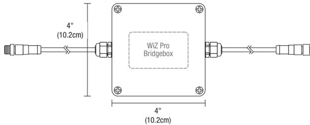
**PURE SMART WET LOCATION JUNCTION BOX WITH 8FT POWER CABLE AND WIZ PRO UR BRIDGEBOX**
