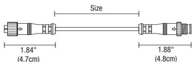
**24VDC INPUT POWER 4 PIN CABLE CONNECTOR WET LOCATION**
